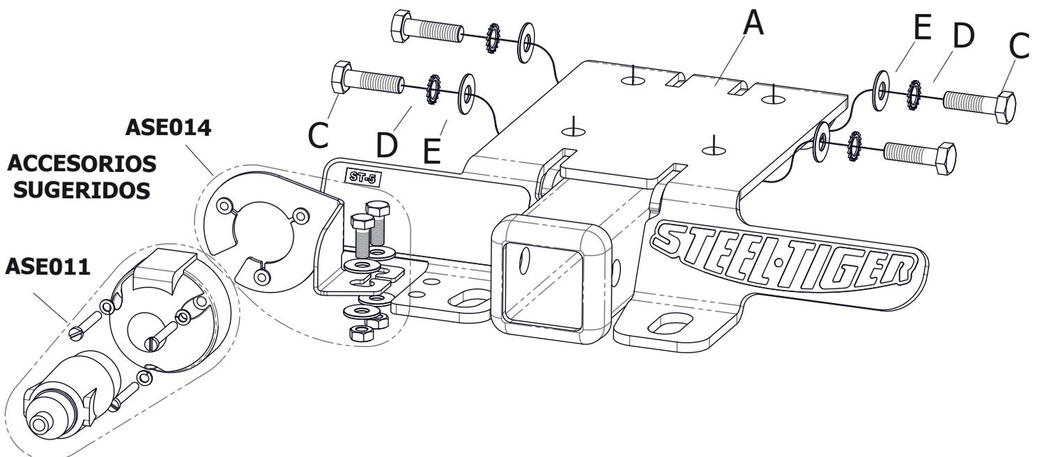
SUJETAR LA PIEZA "A" UTILIZANDO LOS TORNILLOS Y ARANDELAS SUMINISTRADAS (C, D Y E), MEDIANTE LOS AGUJEROS ROSCADOS UBICADOS EN LA CARA INFERIOR DE LA ESTRUCTURA DEL PARAGOLPES.
